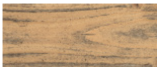
Drewno surowe lub konwencjonalnie olejowane bez ochrony UV
